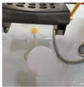
connecter l'ensemble de l'étape 1 au connecteur jaune du bassin - connect step 1 assy to the yellow connector in the basin
